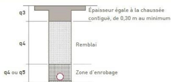
Tranchée sous accotements
